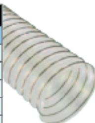
**Structure :** Gaine flexible faite d'une paroi polyuréthane polyéther souple de qualité alimentaire selon la norme **CE 10/2011** modifiée, renforcée d'une spirale en acier ressort cuivrée pour une mise à la terre. Sans halogène et sans plastifiant.
