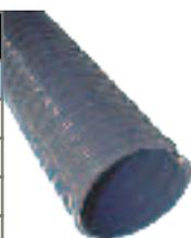
**Structure :** Gaine flexible de poids moyen, faite d'une paroi en PVC souple renforcée d'une spirale en PVC rigide de qualité antichoc. Surface intérieure très lisse. PVC classé au feu selon la norme UL94 VO.
