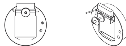
Nebenluftvorrichtung, Regelbereich von 10 bis 25 Pa Modérateur de tirage, gamme d'ajustement de 10 jusqu'à 25 Pa
